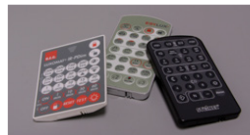
^ Afstandsbedieningen voor het uitvoeren van de afstelling van lichtregelsystemen
